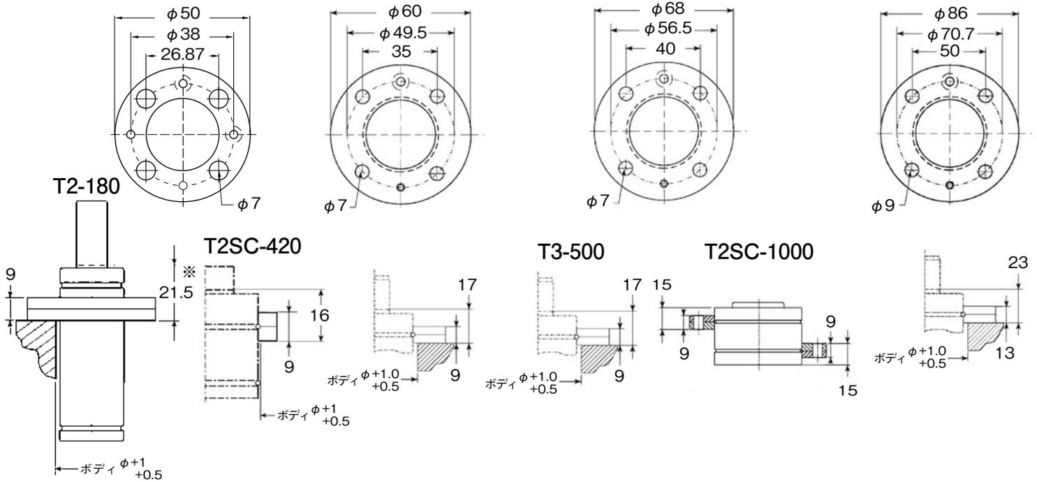
※T2-180シリンダーにはシリンダーピストン側に2本の溝があります。図では下側を使用した場合で21.5mmとなります。上側の溝を使用した場合は16mmとなります。
