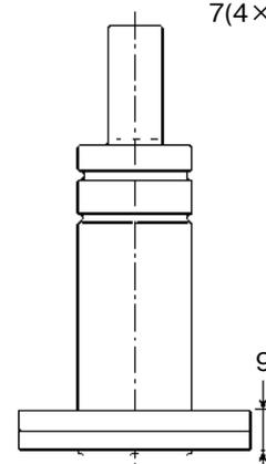
注) T2-180シリンダーにはシリンダーピストン側に2本の溝があります。図では下側を使用した場合で21.5mmとなります。上側の溝を使用した場合は16mmとなります。
